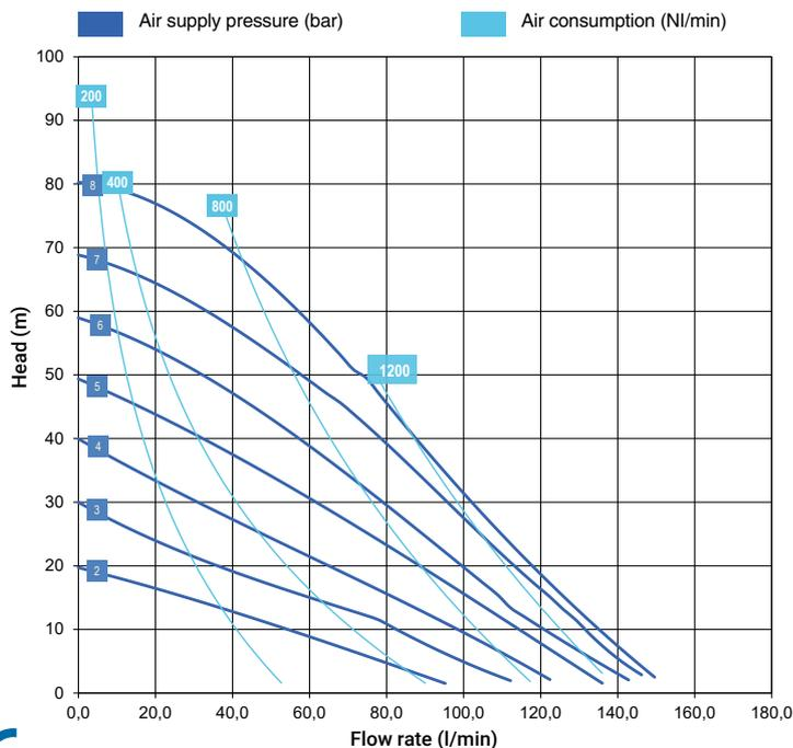
\* Les courbes et performances se réfèrent à des pompes à aspiration immergée et orifice de reflux libre, avec de l'eau à 20 °C, et varient selon la composition des matériaux.
