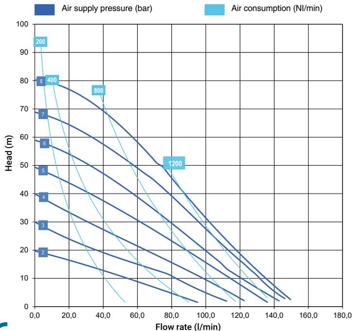
\* Die Kurven und Leistungen beziehen sich auf Pumpen mit eingetauchtem Ansaug- und freiem Auslasstutzen, mit Wasser bei 20 °C und variieren je nach den Materialien der Zusammensetzung.
