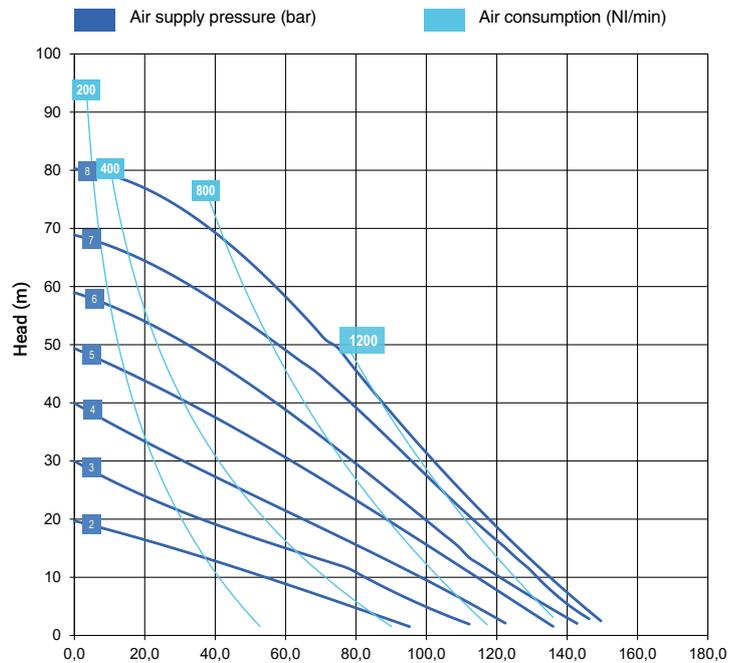
\* Die Kurven und Leistungen beziehen sich auf Pumpen mit eingetauchtem Ansaug- und freiem Auslasstutzen, mit Wasser bei 20 °C und variieren je nach den Materialien der Zusammensetzung.
