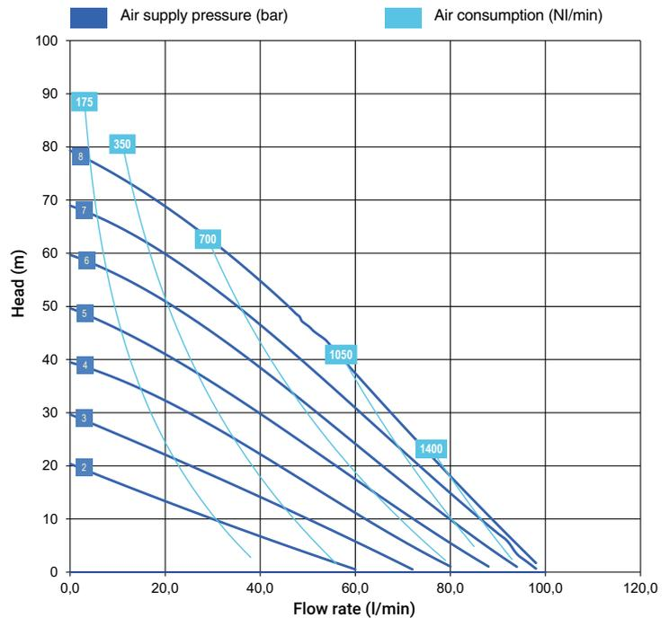
\* Las curvas y los rendimientos se refieren a bombas con aspiración sumergida y boca de descarga libre, con agua a 20 C y varían en función de los materiales de composición.
