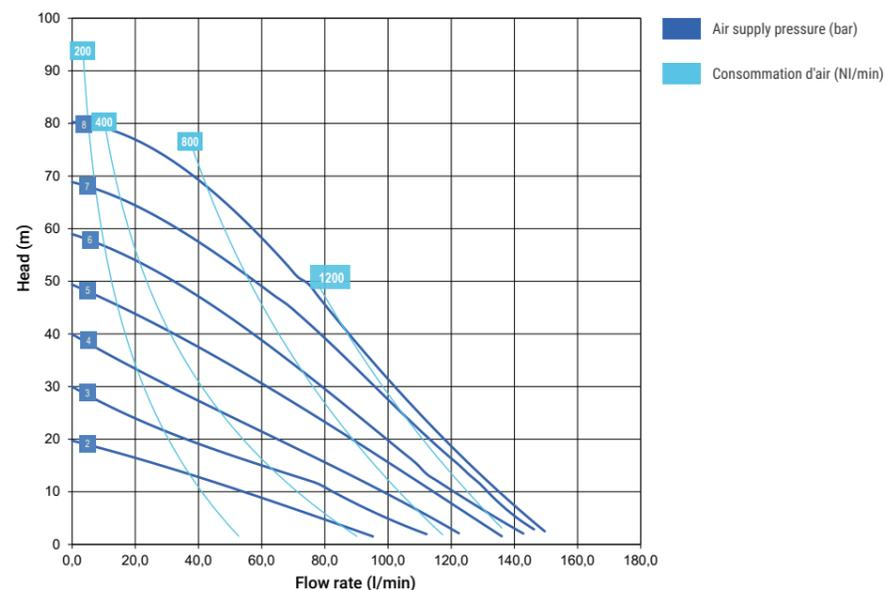
\*Les courbes et les performances font référence à des pompes avec aspiration immergée et bouche de refoulement libre, avec eau à 20 °C, et varient en fonction des matériaux de composition.
