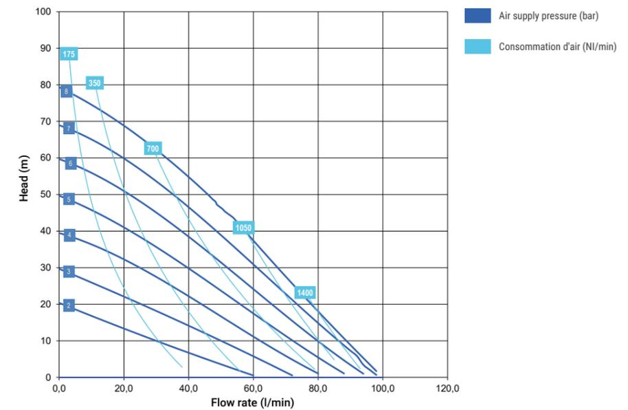
\*Les courbes et les performances font référence à des pompes avec aspiration immergée et bouche de refoulement libre, avec eau à 20 °C, et varient en fonction des matériaux de composition.
