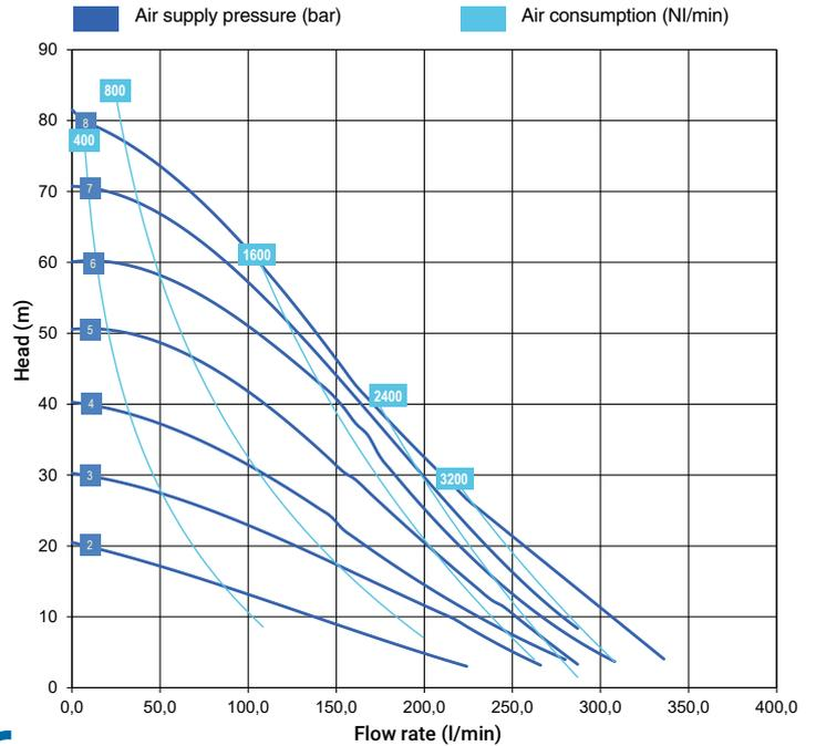
\* Les courbes et performances se réfèrent à des pompes à aspiration immergée et orifice de reflux libre, avec de l'eau à 20 °C, et varient selon la composition des matériaux.
