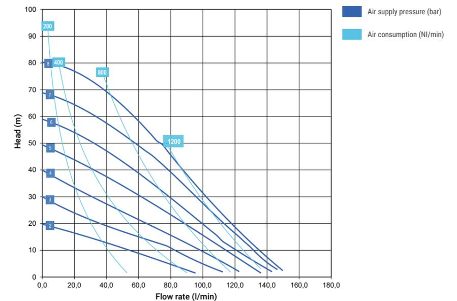
\*Die Kurven und Leistungswerte beziehen sich auf Pumpen mit positive Saugstrecke und freiem Auslauf bei einer Wassertemperatur von 20°C und können je nach Materialzusammenstellung variieren.
