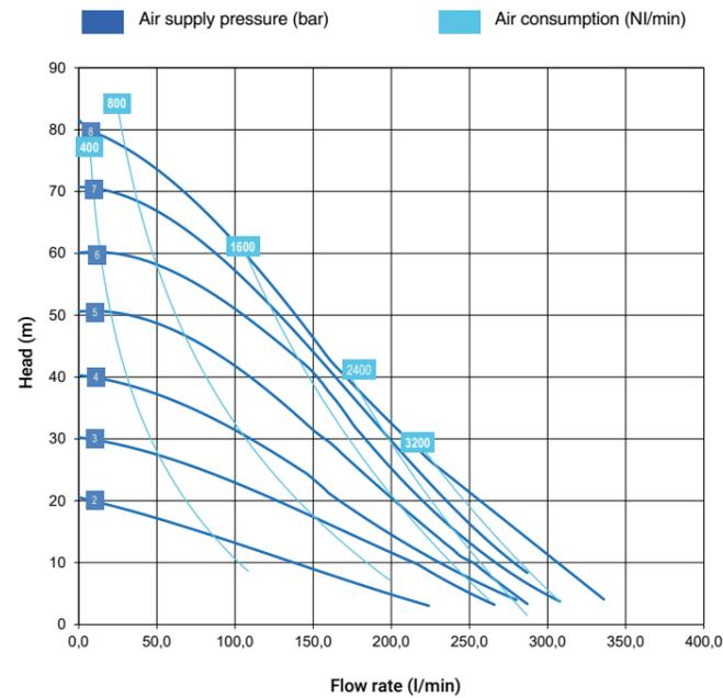
\* Les courbes et performances se réfèrent à des pompes à aspiration immergée et orifice de refoulement libre, avec de l'eau à 20 °C, et varient selon la composition des matériaux.
