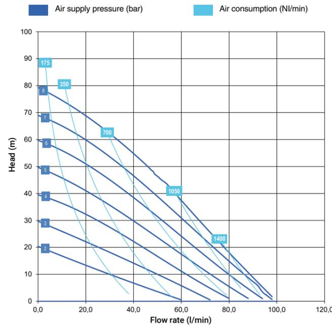
\* Les courbes et performances se réfèrent à des pompes à aspiration immergée et orifice de refoulement libre, avec de l'eau à 20 °C, et varient selon la composition des matériaux.
