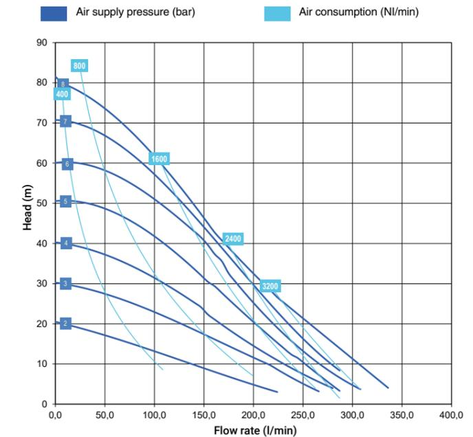
\* Les courbes et performances se réfèrent à des pompes à aspiration immergée et orifice de refoulement libre, avec de l'eau à 20 °C, et varient selon la composition des matériaux.
