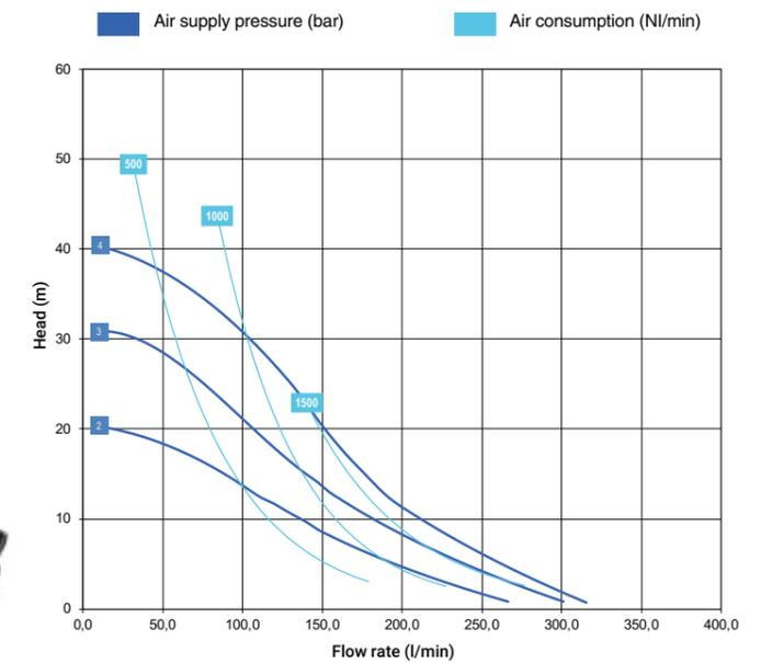
\* Les courbes et performances se réfèrent à des pompes à aspiration immergée et orifice de refoulement libre, avec de l'eau à 20 °C, et varient selon la composition des matériaux.
