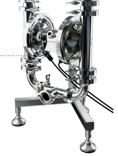
Die Funktionsweise der optischen Sensoren beruht auf dem Aussenden von IR-Strahlung (Infrarot) innerhalb eines Prismas und der Messung der empfangenen Lichtmenge. Wenn die Flüssigkeit den Sensorkopf erreicht, verringert sich die Menge des empfangenen Lichts schlagartig und die Kontakte werden aktiviert.
