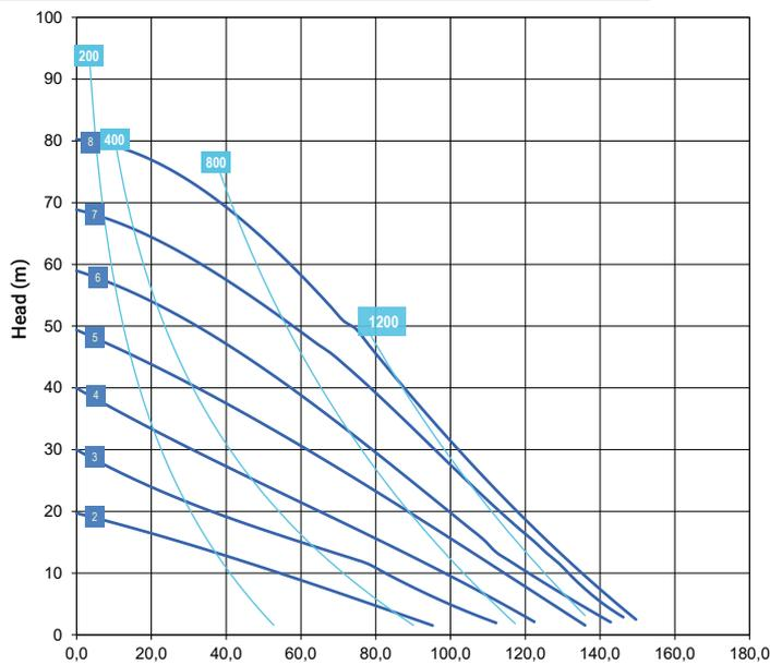
\* Las curvas y los rendimientos se refieren a bombas con aspiración sumergida y boca de descarga libre, con agua a 20 C y varían en función de los materiales de composición.
